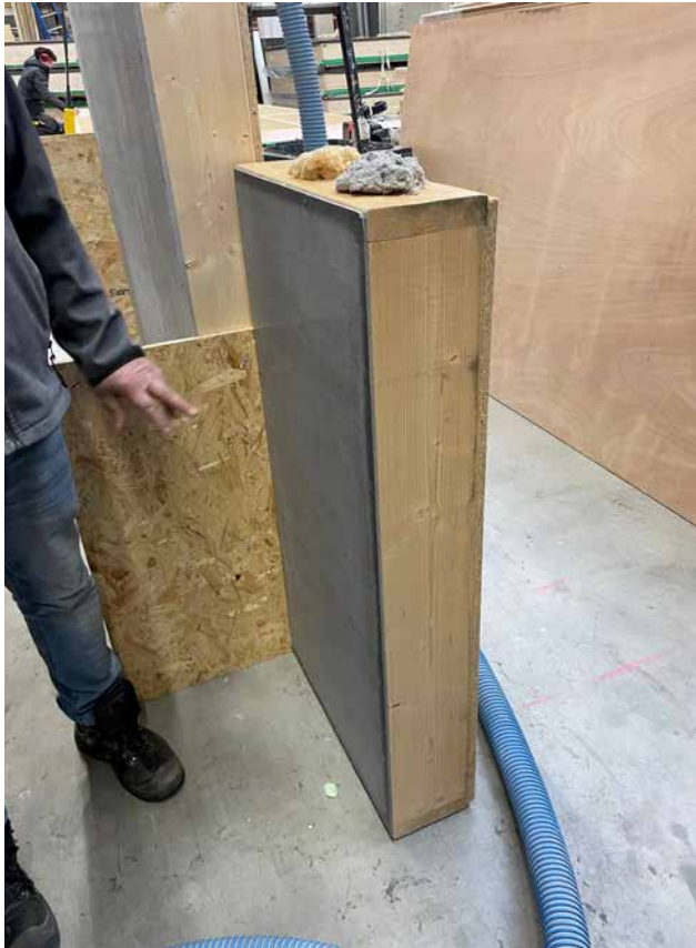
Zelfs bij een extreme overdruk brak of barstte de 4,5 millimeter Wettershield-plaat niet, terwijl een vergelijkbare 9 millimeter plaat van ander materiaal wel bezweek.
